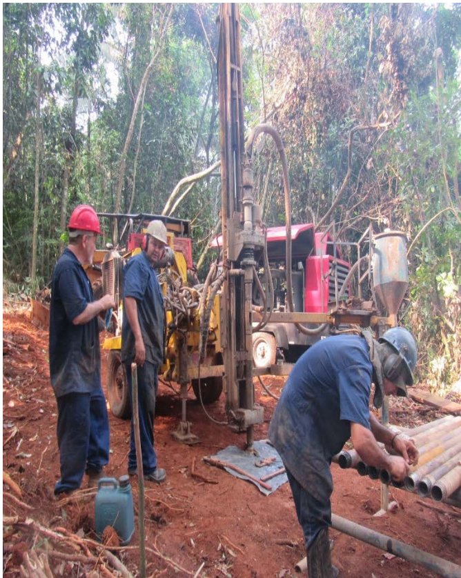
Fig 3. RC drill rig at Três Estados
